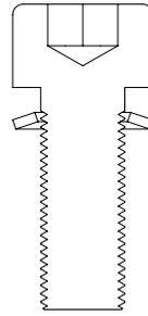
Achte darauf, dass Du die Unterlegscheiben wie hier gezeigt auf die Schrauben legst, um eine ordnungsgemäße Befestigung der Rollen zu gewährleisten.
